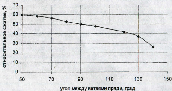
Рисунок 2 - Относительное сжатие пряжи при постоянной силе натяжения в набегавшей ветви 0,5 Н и различном угле между ветвями пряжи
