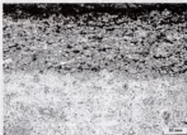
Рис. 4. Микроструктура композиционного покрытия  $Al_2O_3/Cu$ .
