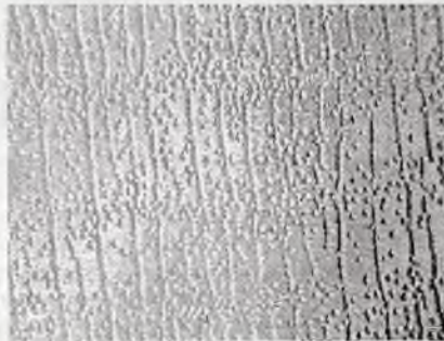
Рис. 4. Дислокационная структура монокристалла KCl типа D после изгиба. T = 650^\circ C, t = 3 часа.
