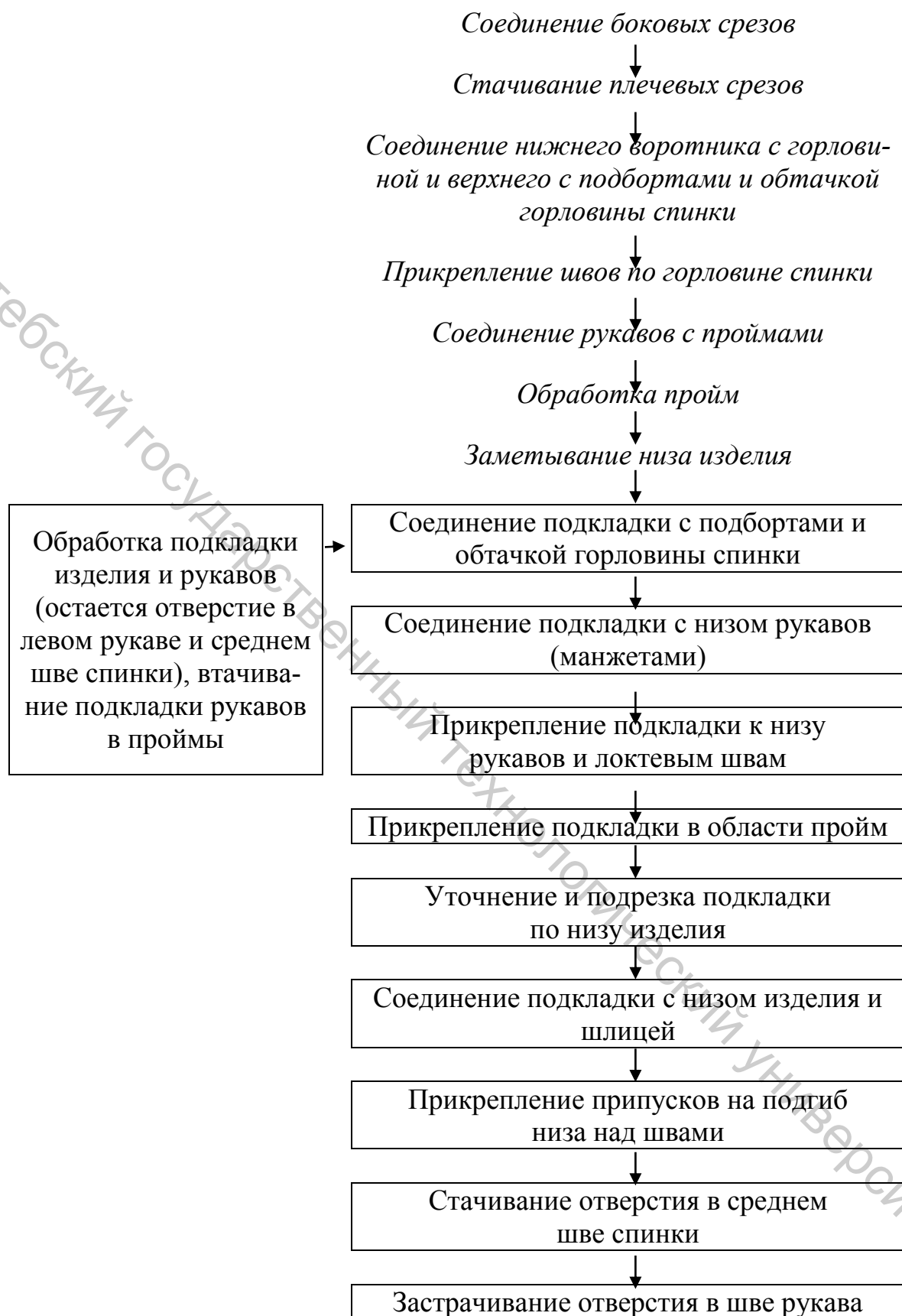
Рисунок 4.95 – Блок-схема соединения притачной по низу подкладки в женских изделиях
