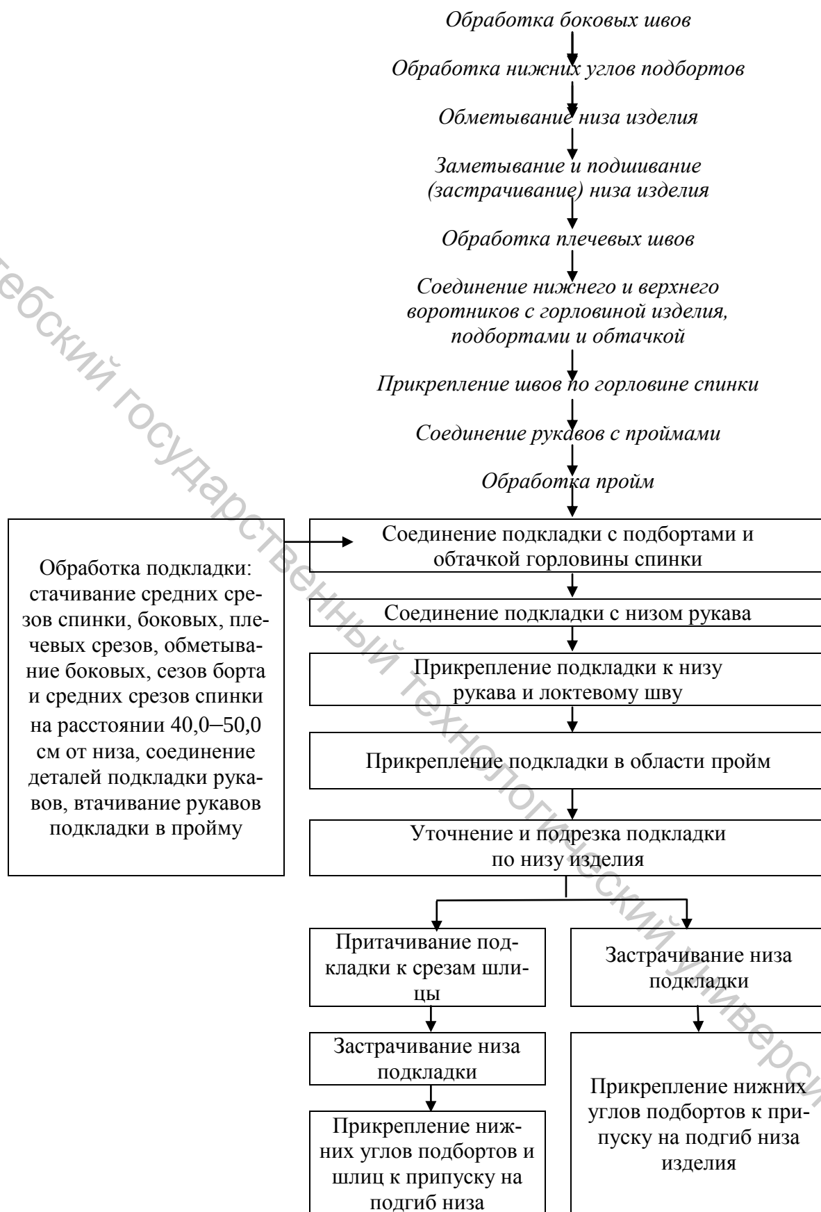
Рисунок 4.100 – Блок-схема соединения подкладки, отлетной по низу, в женских пальто (со шлицей и без шлицы)
