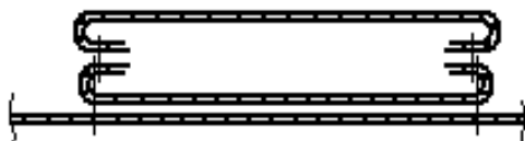
Рисунок 4.29 – «Скрытое» настрачивание концов листочки
