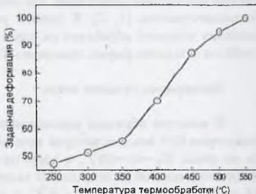
Рис. 3. Зависимость заданной деформации от температуры термообработки TiNi проволоки.
