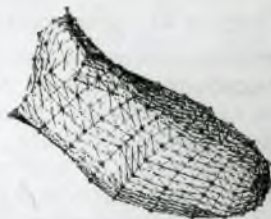
Рисунок 7 – Разбиение поверхности заготовки на треугольные конечные элементы
