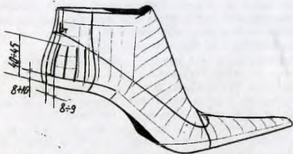
Рисунок 3 – Схема снятия УРК с колодки
