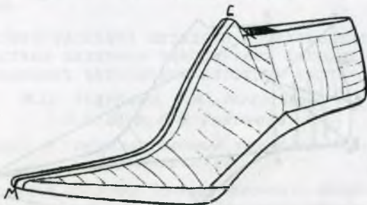
Рисунок 1-Схема оклеивания колодки
