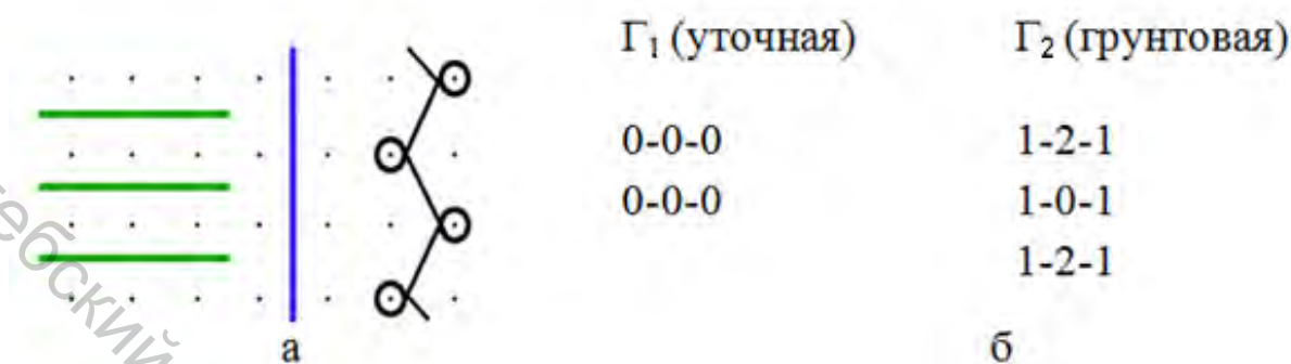
Рисунок 3.62 – Графическая и цифровая записи работы гребенок уточного трикотажа с продольными и поперечными уточными нитями
