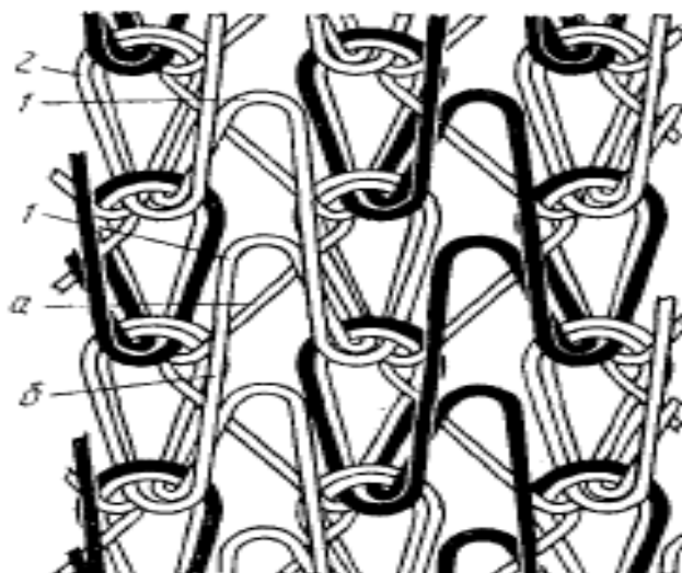
Рисунок 3.31 – Строение трикотажа основовязаного изнаночного петельного плюшевого переплетения на базе трико
