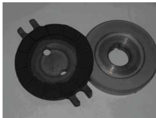
Рисунок 8 – Подпятник и опорная пята с износостойким покрытием хром-УДА и антифрикционной пленкой погружного центробежного насоса марки ЭЦВ
