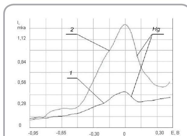
Рисунок 3 – Кривые разности вольтамперных кривых: 1 – пробы и фонового электролита; 2 – пробы с добавкой стандартного раствора и фонового электролита, зарегистрированные с на анализаторе марки АВА-3 при анализе фильтра сигареты №6 PALL MALL NANOKINGS BLUE на содержание ртути. Температура 250 °C
