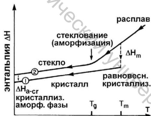
Рисунок 4 – Схема изменения энталпии при получении АС закалкой расплава и при кристаллизации аморфной фазы в условиях нагрева до температур ниже  $T_g$  (по материалам [10])
