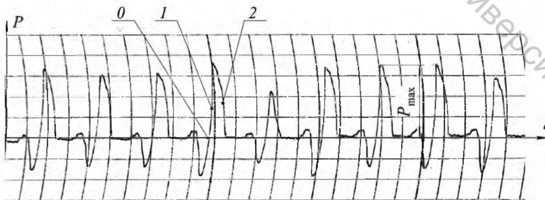
Рисунок 2 – Профилограмма усилия вырубki на протяжении рабочего хода
