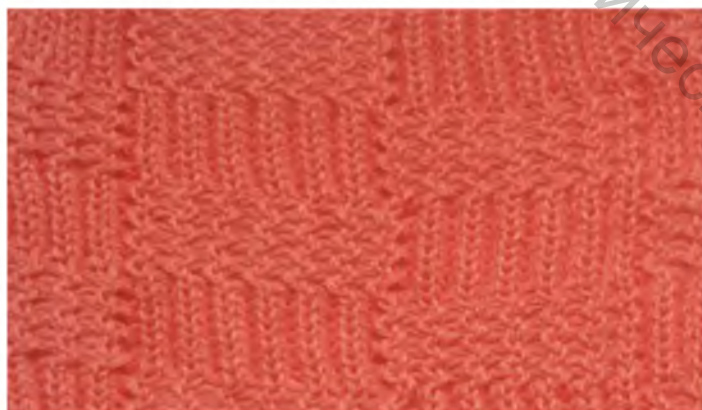
Рисунок 1 – Перекрестный трикотаж на базе неполного двойного фанга с рисунком в клетку
