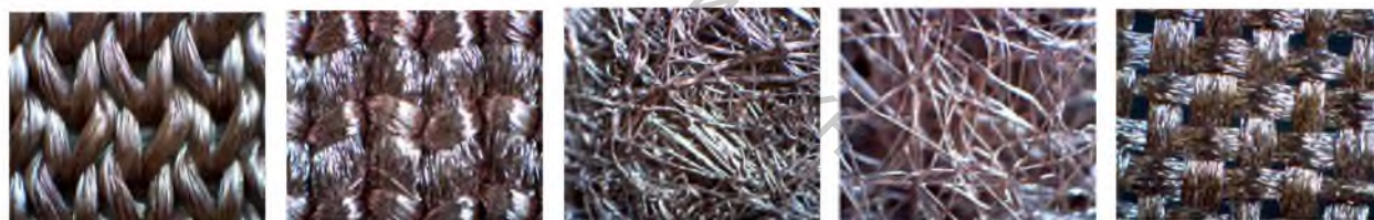
Рисунок 2 – Внешний вид текстильных фильтровальных материалов с наноструктурированными покрытиями меди
