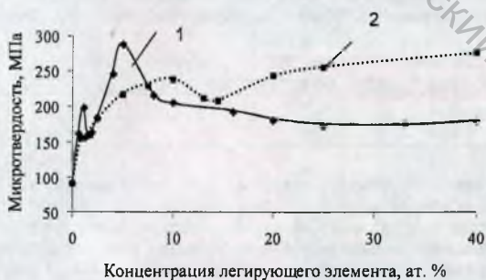
Рисунок 3 - Зависимость микротвердости фольг Sn-Cd и Sn-Zn от концентрации кадмия (1) и цинка (2)
