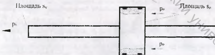
Рисунок 1 - Принцип увеличения давления в системе
