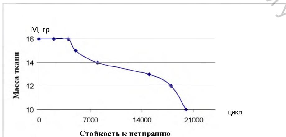
Рисунок 3 - Кривая изменения массы уточноопорной ткани при истирании на приборе M235/3
