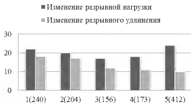
Рисунок 1 – Изменение разрывной нагрузки и разрывного удлинения после 20000 циклов многократного изгиба.
