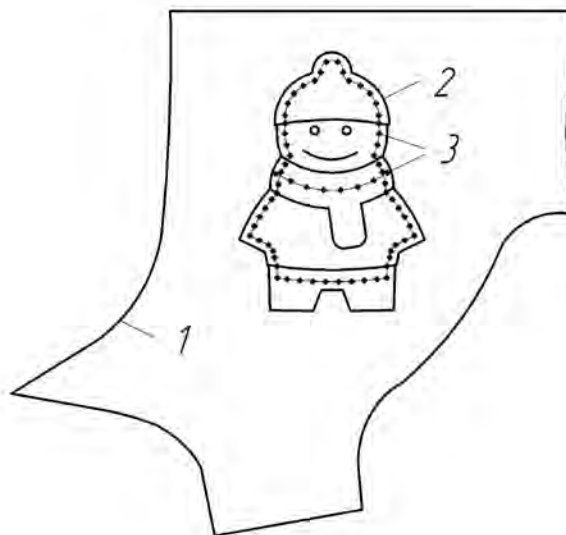
Рисунок 1 – Контуры голенища, деталей аппликации и соединительных строчек Теоретическая производительность обработки определяется по формуле
