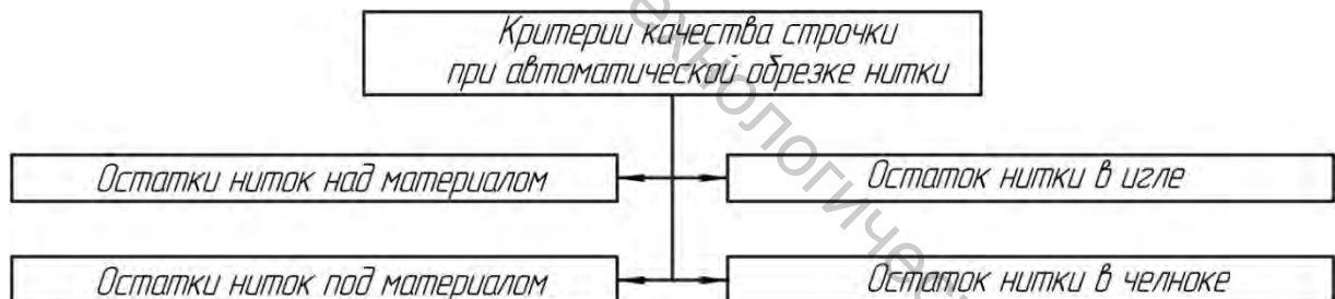
Рисунок 1 – Критерии качества строчки, получаемой в процессе обрезки нитки
