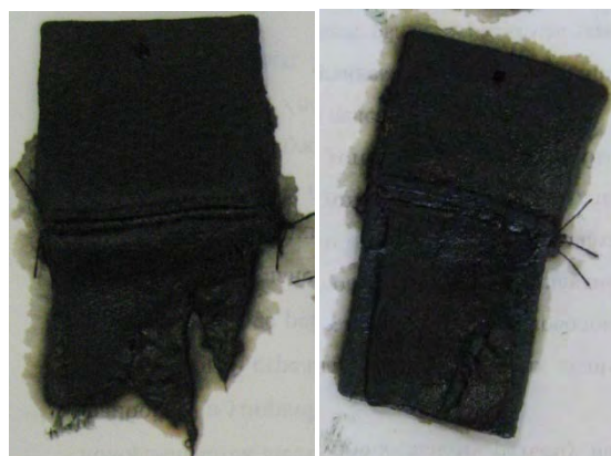
Рисунок 1 – Внешний вид образцов после 4-х часового выдерживания в щёлочи
