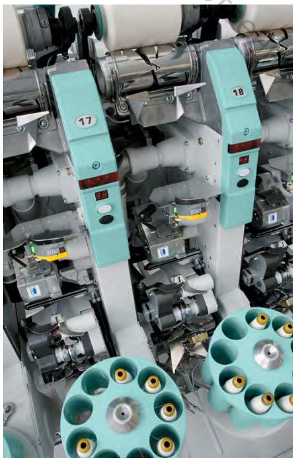
Рисунок 1.3 – Внешний вид (а) и технологическая схема (б) мотального автомата Polar L.
