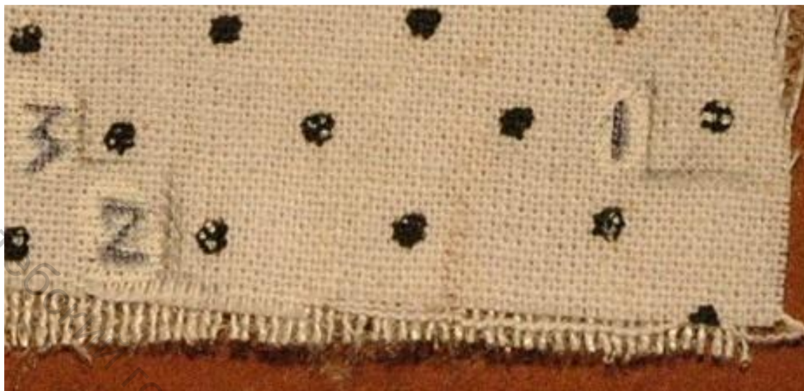
Рисунок 1 - Пример нанесения, контрольных точек на рабочих участках для измерения под микроскопом
