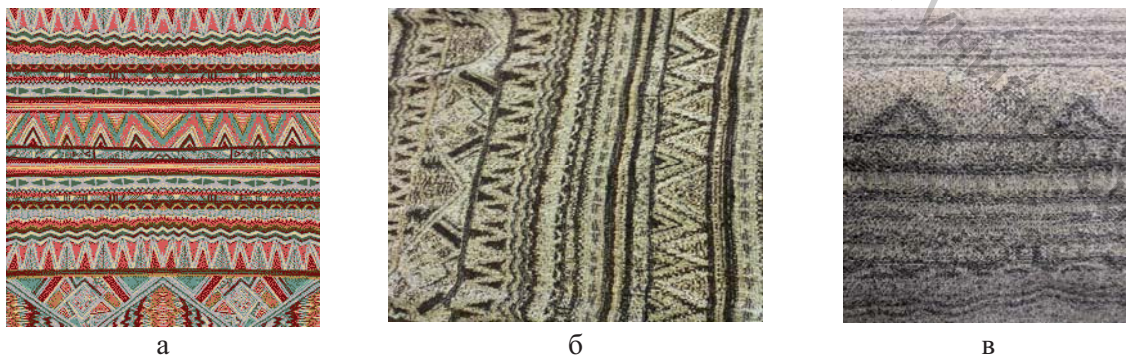
Рисунок 3 – Технический рисунок (а) и внешний вид фрагмента (б, в) гобеленовой ткани с махровым эффектом
