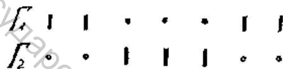
Рисунок 2.50 – Графическая запись основовязаного трикотажа с неполной проборкой
