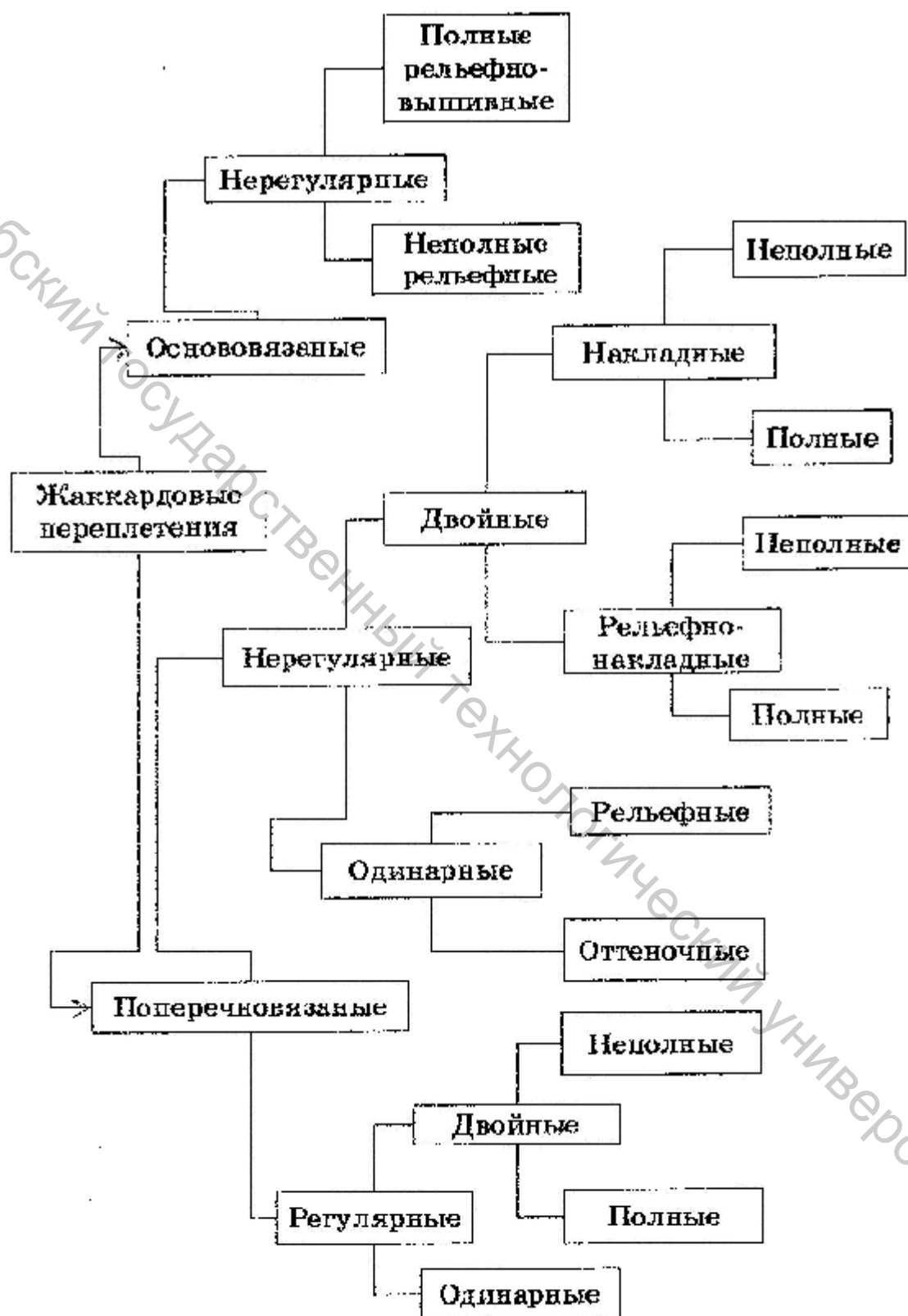
Рисунок 3.13 – Классификация жаккардовых переплетений
