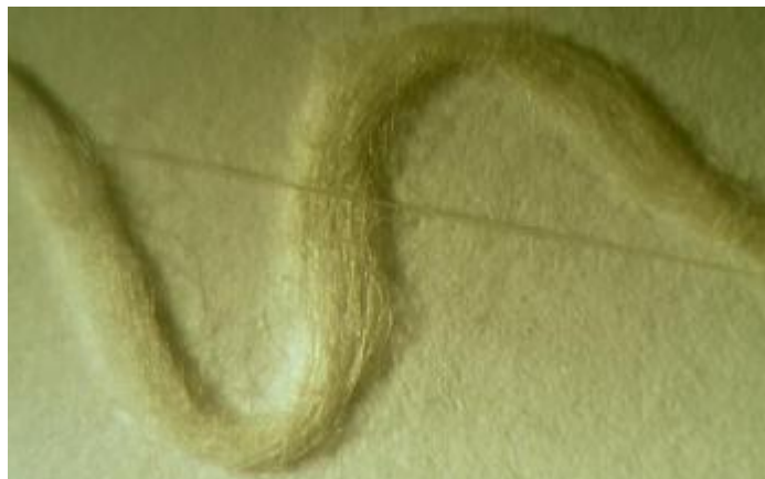
Рисунок 5 – Комбинированная высокоэластичная пряжа пневмомеханического способа прядения после раскручивания на круткомере
