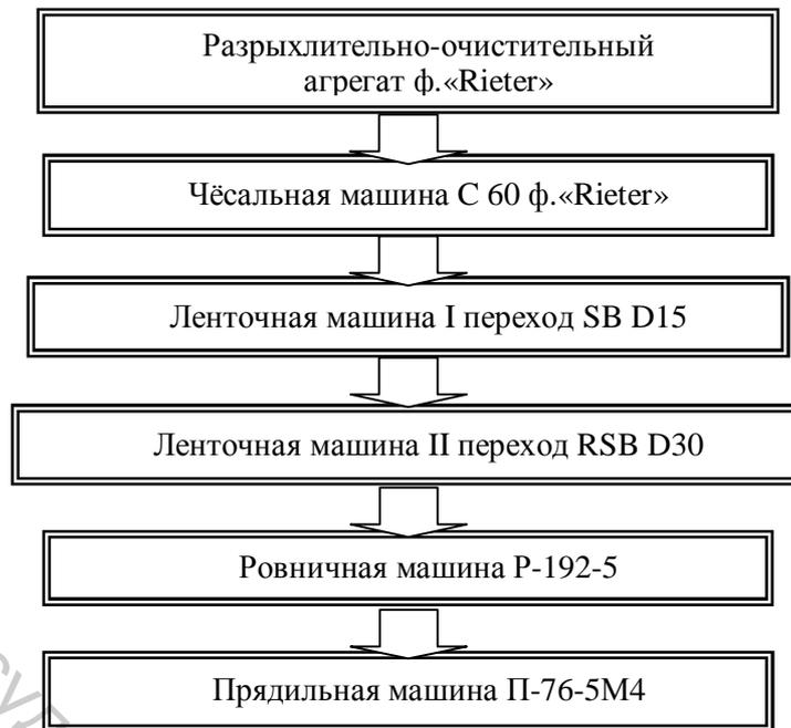
Рисунок 1 - Схема технологического процесса получения хлопкополипропиленовой пряжи
