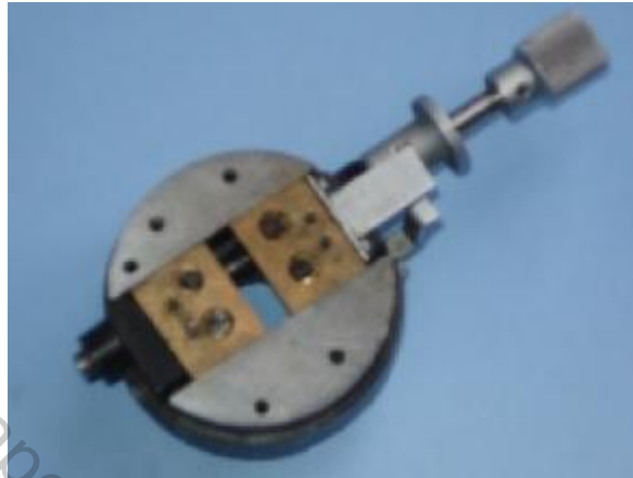
Рисунок 1 – Приставка к микроскопу для изучения структурных перестроек волокна в процессе его ориентационной вытяжки.
