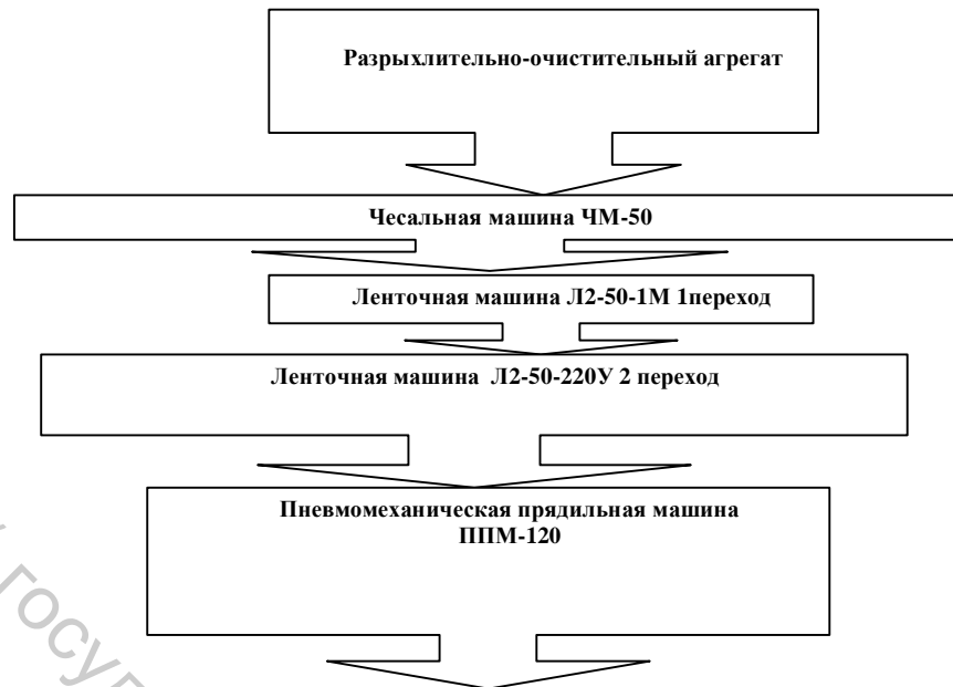
Рисунок 1 - Технологическая схема получения комбинированной пряжи
