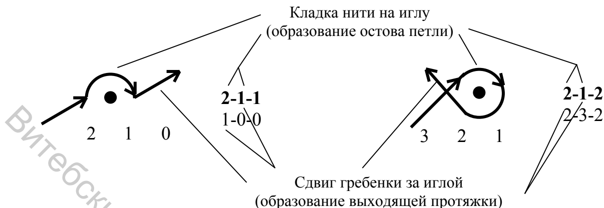
Рисунок 15 – Образование основовязаной петли
