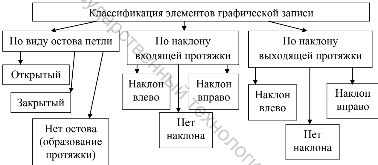
Рисунок 2 – Классификация элементов графической записи основовязаного трикотажа
