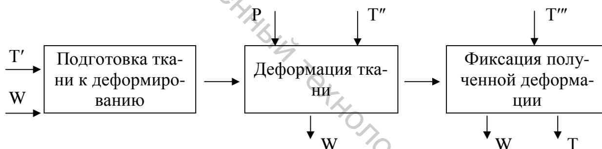
Рисунок 4.2 – Стадии процесса ВТО:  $T'$ ,  $T''$ ,  $T'''$  - подводимое к материалу тепло разных параметров
