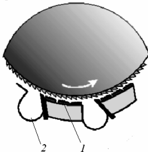
Рисунок 2.8 – Установка неподвижных шляпок и зон очистки под приемным барабаном
