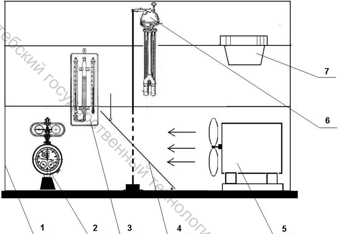
Рис 1.6. Схема экспериментальной установки (стенда) для исследования параметров микроклимата на рабочем месте: 1 – кожух, 2 – анемометр чашечный, 3 – стационарный психрометр Августа, 4 – подвижная пластина для регулирования воздушного потока, 5 – вентилятор, 6 – аспирационный психрометр Ассмана МВ-4М, 7 – барометр
