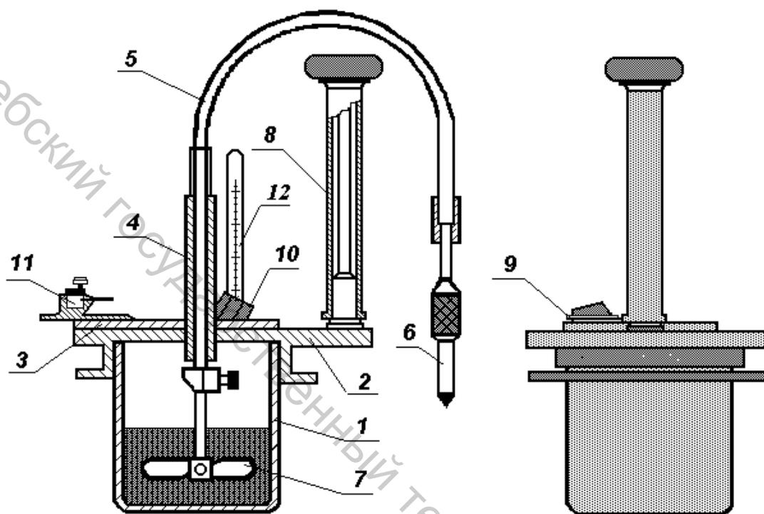
Рис. 6.1. Прибор для определения температуры вспышки вещества в закрытом тигле: 1 – тигель, 2 – крышка тигля, 3 – подвижная заслонка, 4 – трубка, 5 – гибкий вал, 6 – ручка гибкого вала; 7 – лопасти мешалки; 8 – механизм открывания заслонки; 9 – зубец для наклона зажигательной лампочки; 10 – трубка для установки термометра; 11 – фитильная зажигательная лампочка; 12 – ртутный термометр
