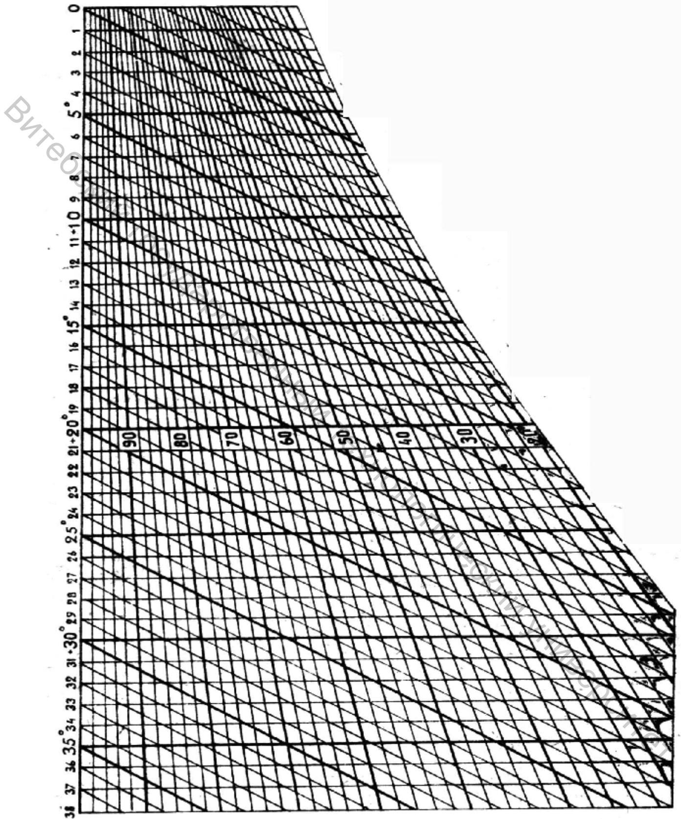
Рис. 1.3. Номограмма для определения влажности для психрометра Ассмана
