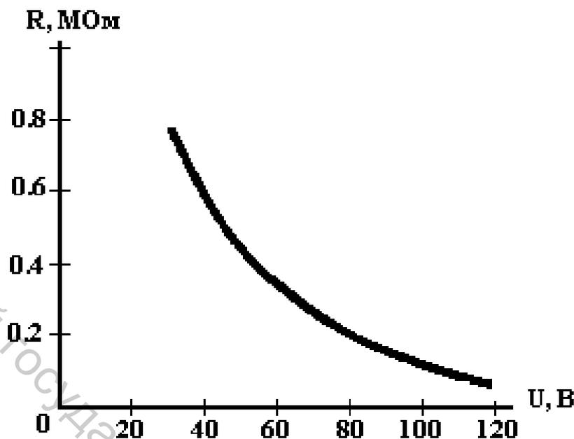
Рис. 8.1. Зависимость сопротивления изоляции  $R_{ИЗ}$  от приложенного напряжения  $U$
