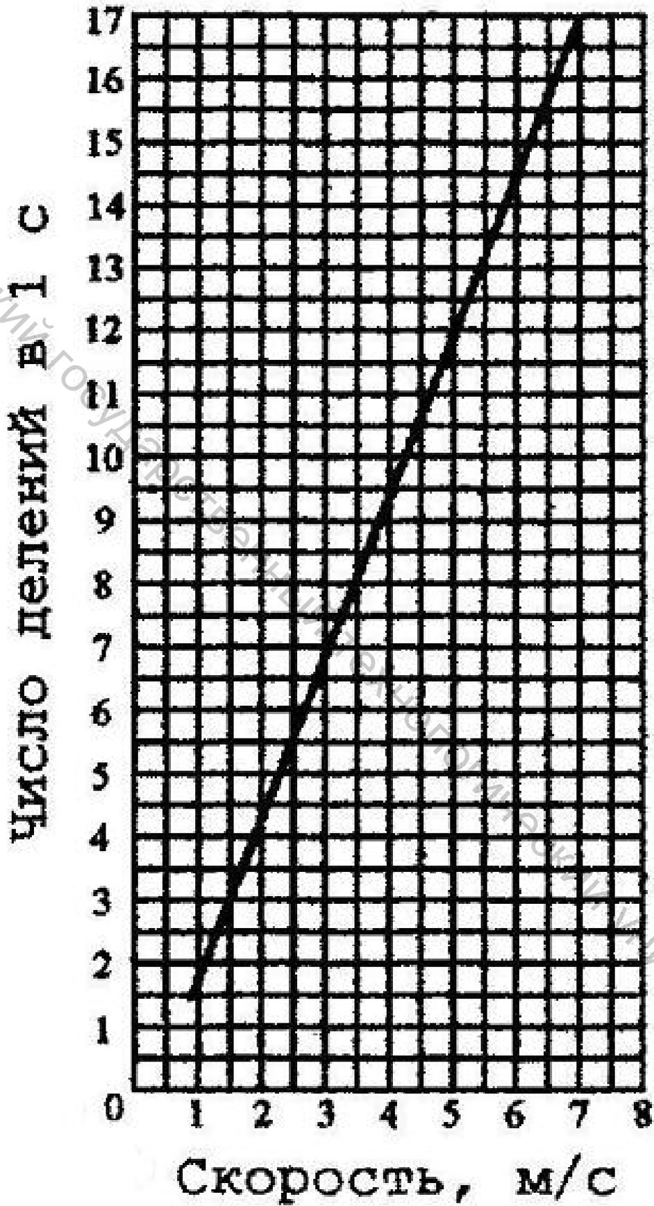
Рис.1.5. Тарировочный график для определения скорости движения воздуха чашечным анемометром
