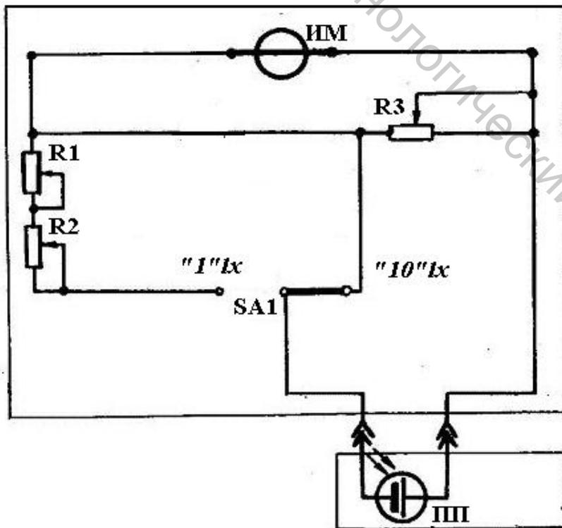
Рис. 3.4. Принципиальная схема люксметра Ю-116: ИМ – измерительный механизм;  $R1 = 150 \text{ кОм}$ ,  $R2 = 8,2 \text{ кОм}$ ,  $R3 = 100 \text{ Ом}$ ; ПП – фотоэлемент; SA1 – переключатель пределов измерений
