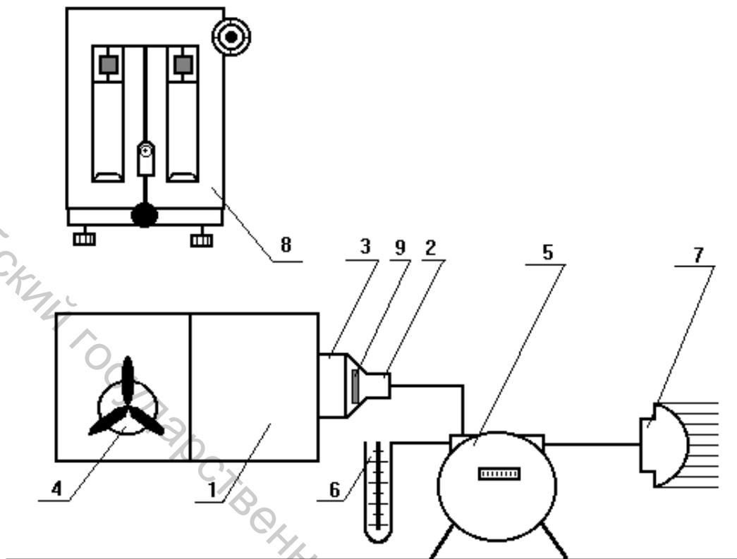
Рис. 2.1. Схема экспериментальной установки для исследования запыленности воздуха
