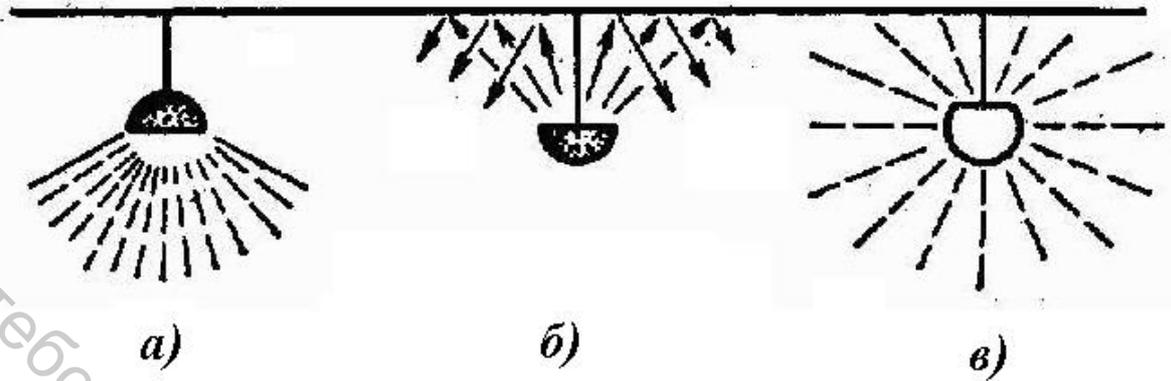
Рис. 4.2. Распределение светового потока в светильниках: а – прямой и преимущественно прямой; б – отраженный и преимущественно отраженный; в – рассеянный
