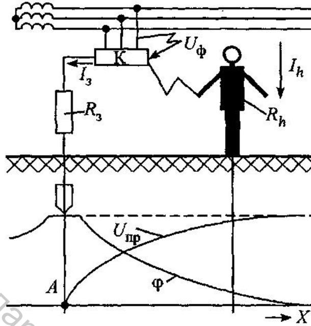
Рис. 5.1. Принципиальная схема защитного заземления: потенциальная кривая  $\varphi(x)$ ; напряжение прикосновения  $U_{пр}$ ;  $K$  - корпус электроустановки;  $R_3$  - сопротивление заземления;  $R_h$  - электрическое сопротивление тела человека
