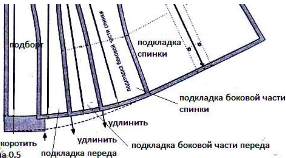
Рисунок 2.29 – Конструирование складки (напуска) по линии низа подкладки жакета
