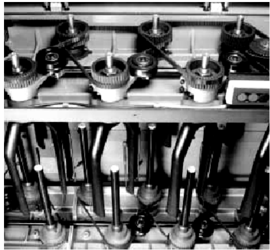
Рис. 1.41. Передача движения катушкам и рогулькам на ровничной машине F 33
