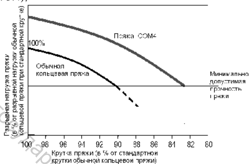
Рис. 3.4. Зависимость разрывной нагрузки обычной и компактной пряж от крутки
