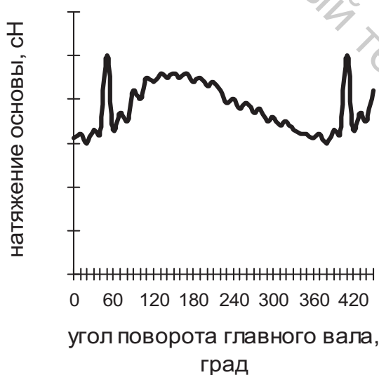
Рисунок 1 – Кривая изменения натяжения основы за один оборот главного вала
