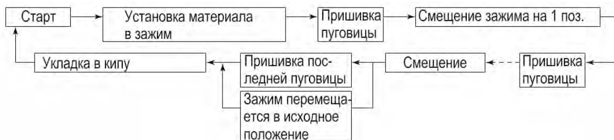
Рисунок 1.8 – Схема шитья в автоматическом режиме
