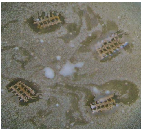
Рисунок 5 – Покрытые азотнокислым серебром образцы в среде бактерий
