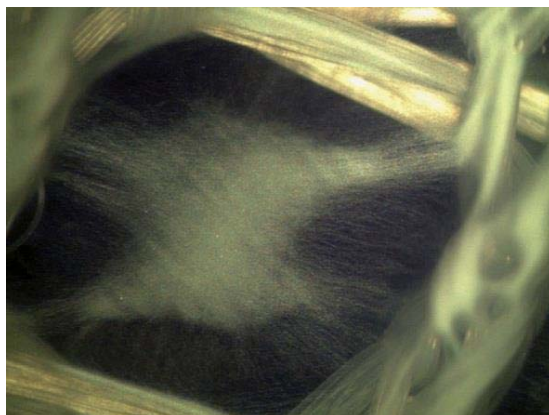
Рисунок 2 – Покрытие антибиотиком основовязаного образца в один слой
