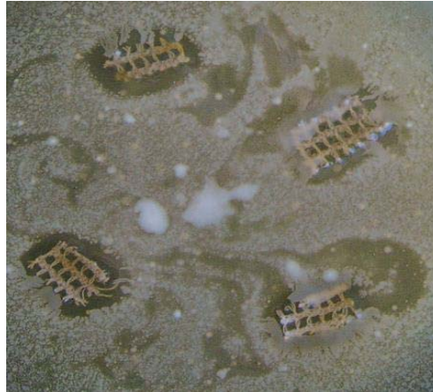
Рисунок 5 – Покрытые азотнокислым серебром образцы в среде бактерий
