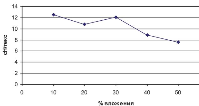
Рисунок 2 – Зависимость разрывной нагрузки пряжи от процентного вложения котонизированного льна
