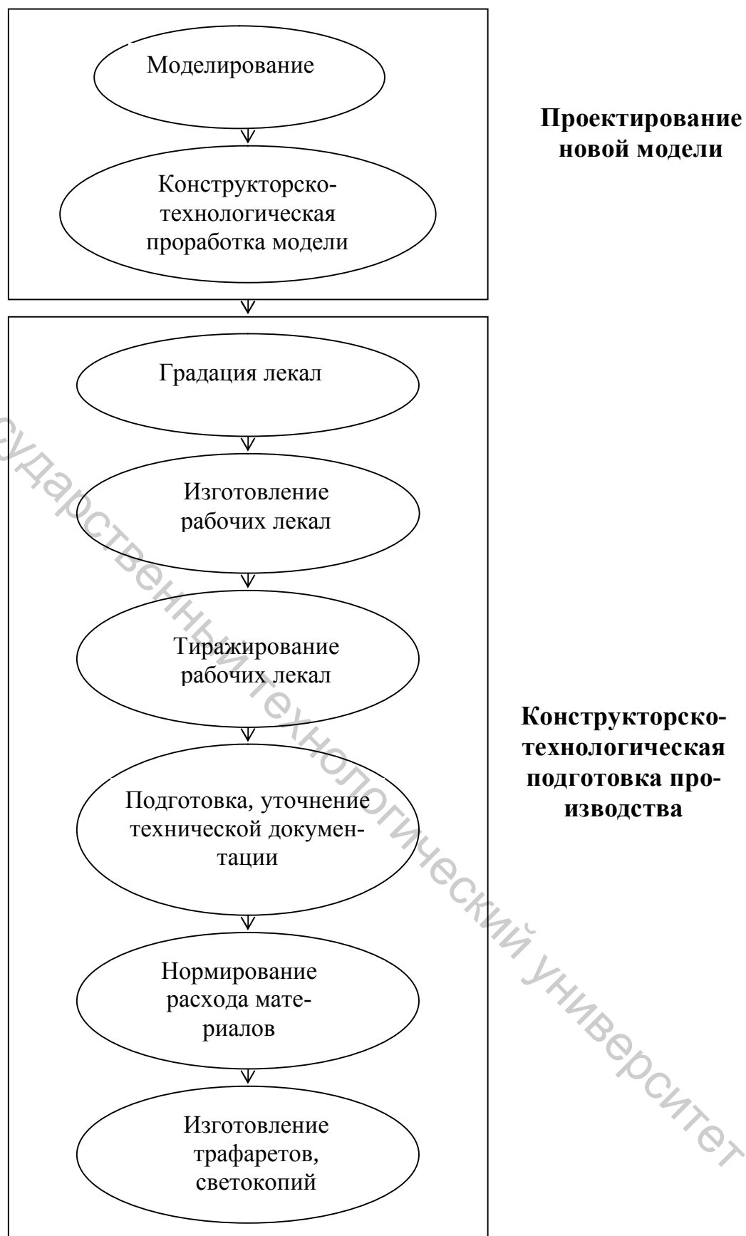
Рисунок 2.1 – Схема работ по проектированию новых моделей и конструкторско-технологической подготовке производства
