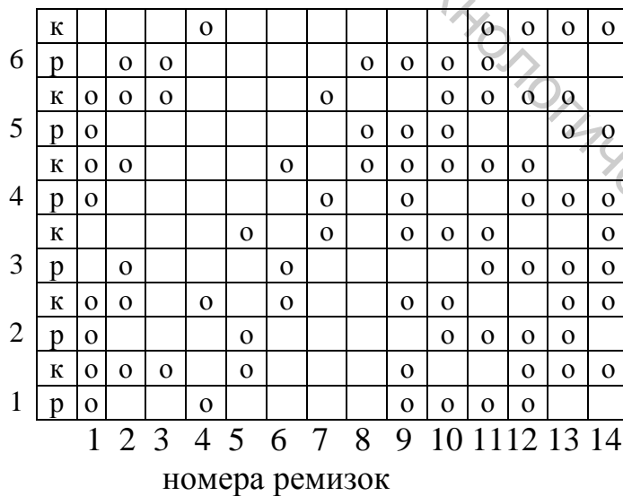
Рис. 1.2 – Заправочный рисунок ткани для бесчелночного ткацкого станка СТБ с ремизоподъемной кареткой СКР:
