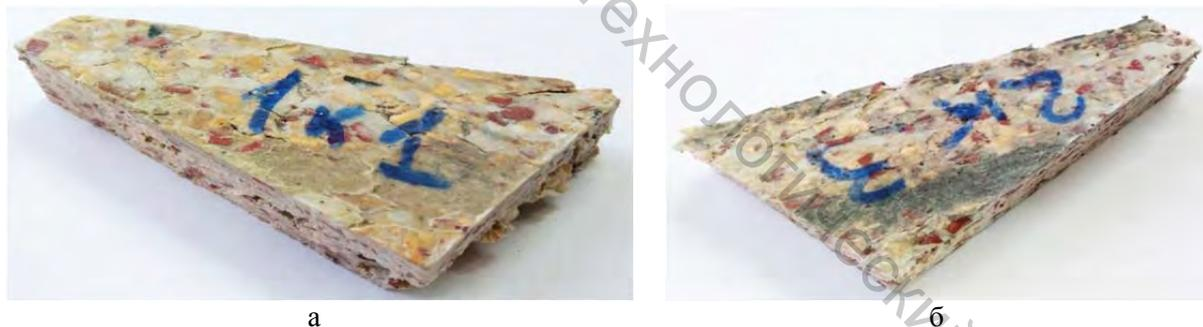
а – образец, полученный при смешивании отходов стелечных картонов и термопластических материалов в соотношении 1:1; б – образец, полученный при смешивании отходов стелечных картонов и термопластических материалов в соотношении 2:3.
