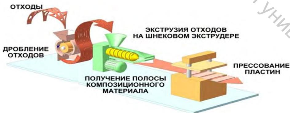
Рисунок 1 – Технологическая схема процесса изготовления вкладыша
