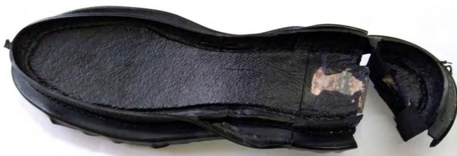
Рисунок 3 – Отлитая подошва с образцом вкладыша
