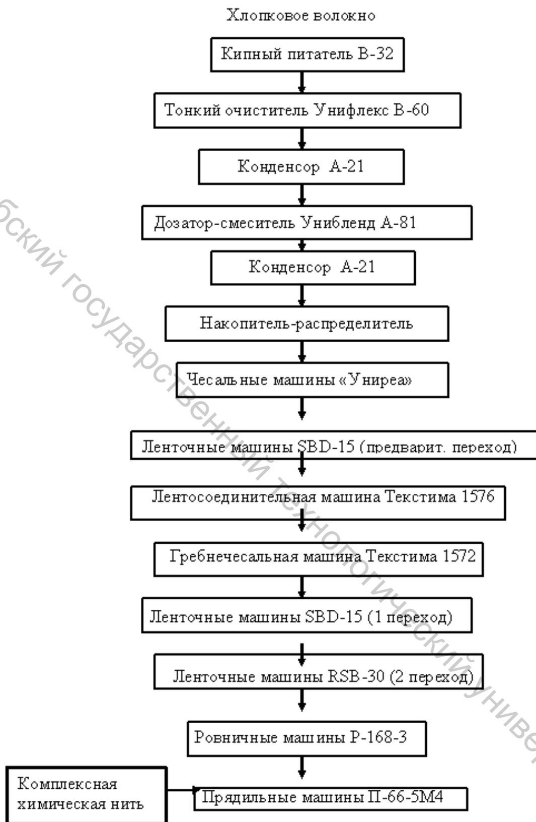
**Рисунок 7.4. Принципиальная схема технологической линии для выработки комбинированной хлопкохимической пряжи**
