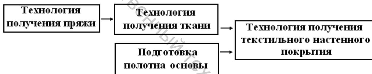
**Рисунок 8.2. Технологическая цепочка получения текстильных настенных покрытий**
