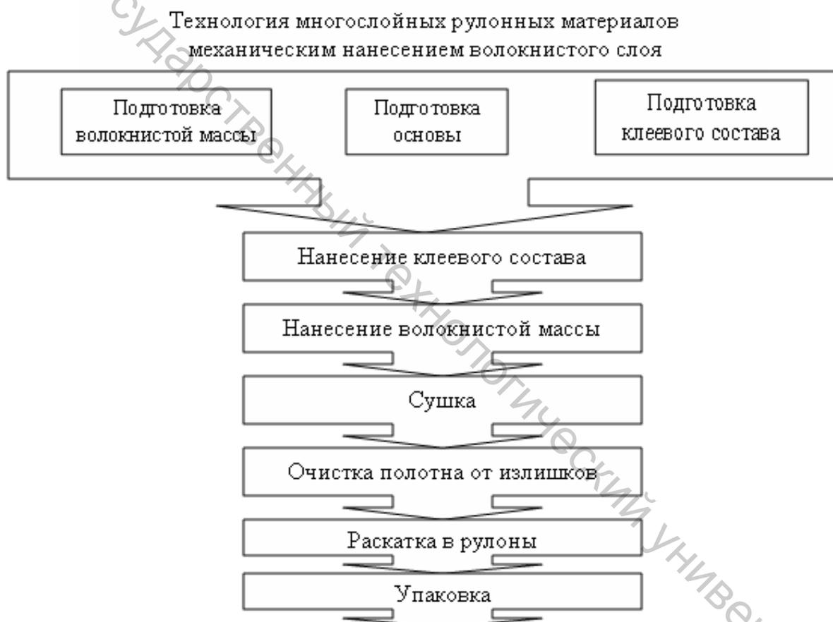
**Рисунок 10.1. Схема технологического процесса изготовления многослойных рулонных материалов**
