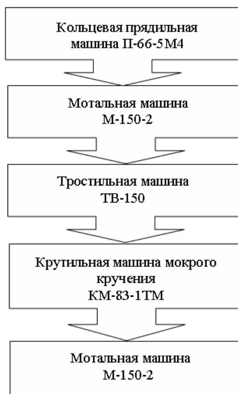
**Рисунок 7.5. Технологическая цепочка получения кручёной пряжи**
