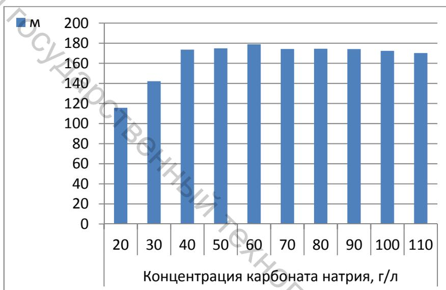
Рисунок 1 – Гистограмма зависимости массы осадка основного карбоната кобальта  $\text{Co}_2(\text{OH})_2\text{CO}_3$  от концентрации раствора  $2\text{Na}_2\text{CO}_3$
