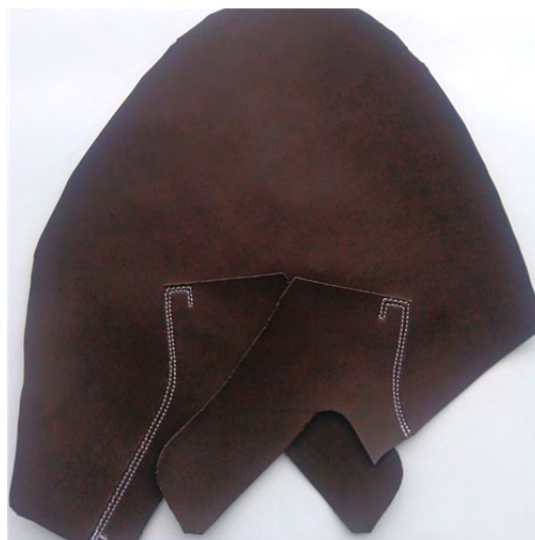
Рисунок 5 – Отшитая заготовка верха обуви
