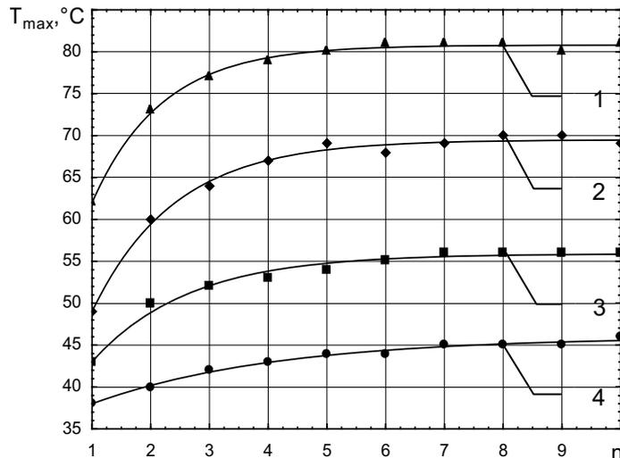
Рисунок 5 – Зависимость максимальной температуры на внутренней поверхности пакета материалов  $T_{max}$  от количества циклов теплового нагружения  $n$  при различных значениях уровня теплового воздействия  $q_n$ :
