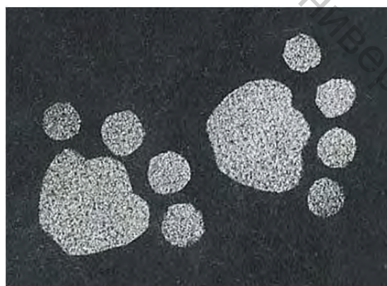
Рисунок 1 – Использование трафаретов при металлическом напылении
