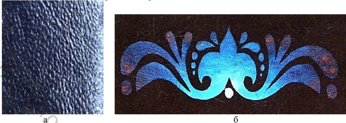
Рисунок 2 – Образец кожаной ткани шубной овчины с отделкой акриловыми красителями: напыление акрилового красителя пульверизатором (а); нанесение акрилового красителя губкой по методу трафаретного крашения (б)
