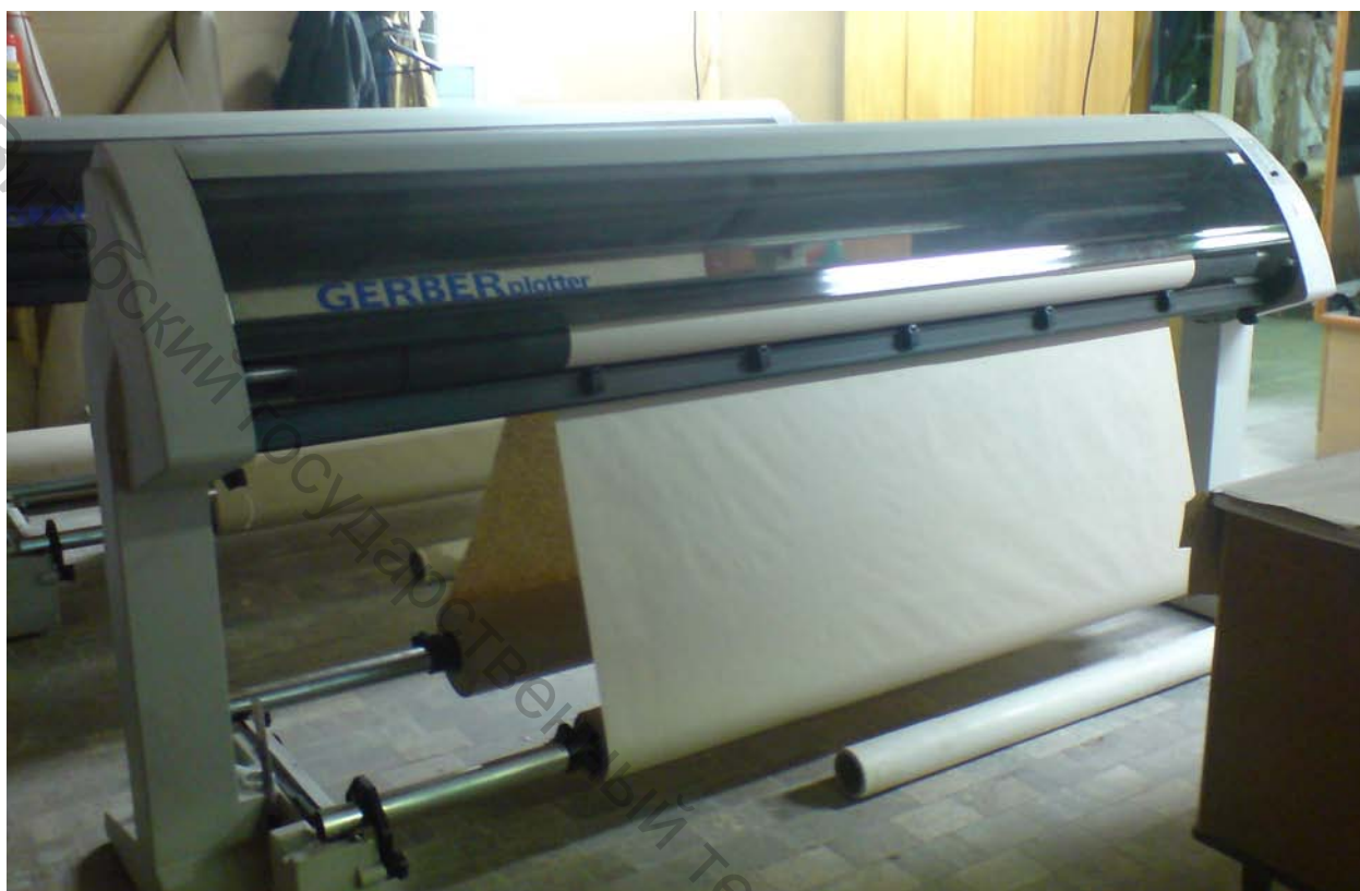
Рисунок 1.3 – Внешний вид плоттера, применяемого в системе Гербер
