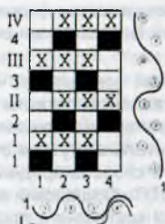
Рисунок 2 – Переплетение полутораслойной ткани
